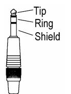
Tip: wiper (pin2) Ring: +5V (pin 3) Shield: GND (pin 1)
