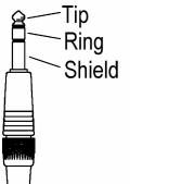
Tip — wiper (pin2) Ring - +5V (pin 3) Shield — GND (pin 1)
